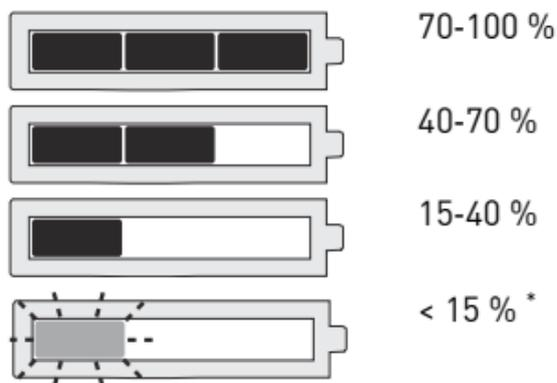
\* **Recommandation** : recharger la batterie avant de continuer à utiliser l'appareil.
